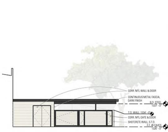
**3 MECHANICAL ENCLOSURE EAST ELEVATION**
